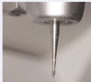
Feiner rotierender Hartstahlbohrkörper im roten Winkelstück (GENTLEpower)
